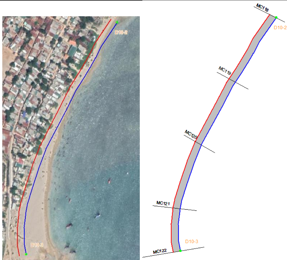
Hình 34. Ranh giới hành lang bảo vệ bờ biển KV6, đoạn 4
